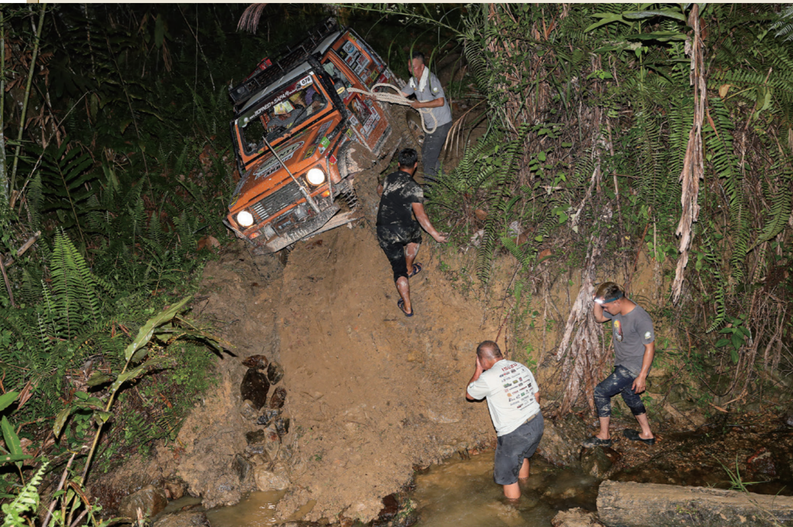
延々と続くクロッカー山脈の峠に、ラガーのATが音を上げた。バンパー裏のATFクーラーを水冷して事なきを得る。
