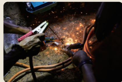
ジャングルでのラフサービスでは、幾度となくバッテリーによるアーク溶接が行われたが、ほぼ完璧な修理だ。
