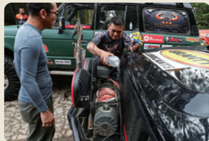
延々と続くクロッカー山脈の峠に、ラガーのATが音を上げた。バンパー裏のATFクーラーを水冷して事なきを得る。
